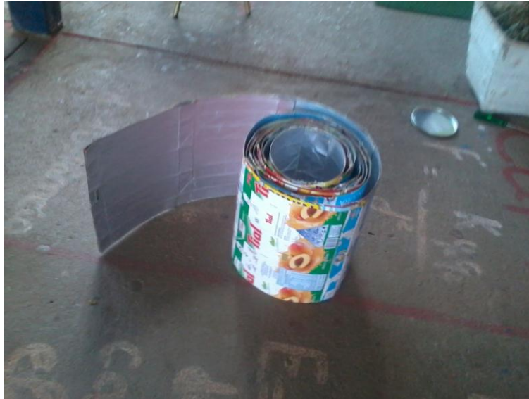
Figura 3.6 – PIT pronto para cobertura do telhado da sala de Física.
