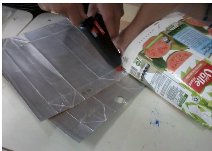
Figura 3.1 – A primeira fase de colagem com cola de silicone a quente na face do alumínio do compósito híbrido (embalagem da Tetra Pak).
