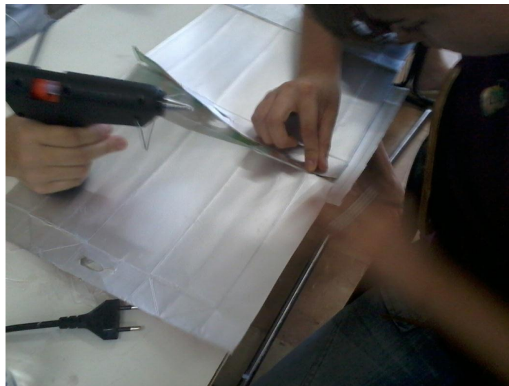
Figura 3.2 – Duas caixas compósitas unidas por cola de silicone a quente.
