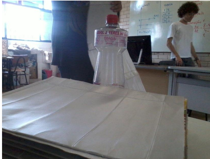
Figura 3.4 – Limpeza de resíduos gordurosos de camadas compósitas para a laminação com cola de contato.
