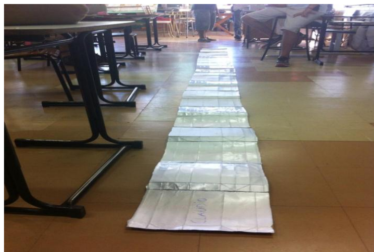
Figura 3.3 – Lâmina compósita de 6000 mm constituída de 23 a 26 de embalagem da Tetra Pak, coladas com silicone nas extremidades de 30 mm
