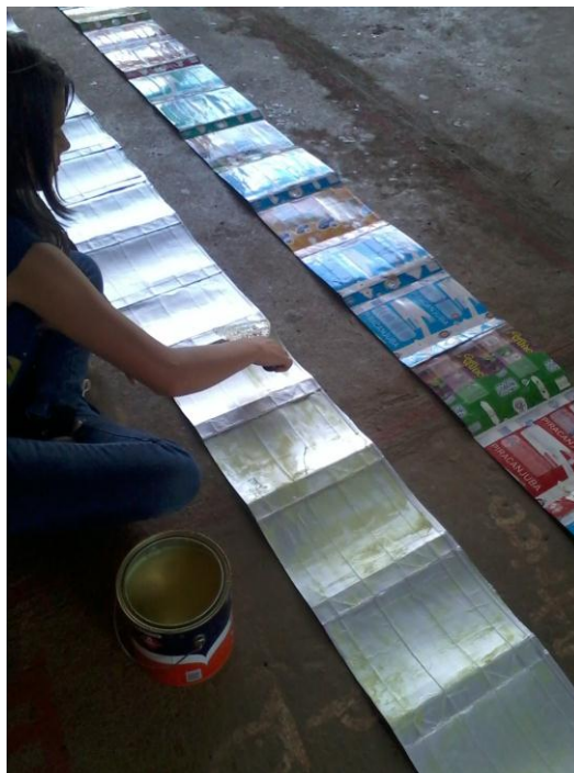
Figura 3.5 – Laminação das três camadas de comprimento de 6000 mm de embalagens compósitas da Tetra Pak.
