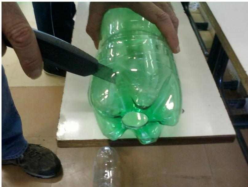
Figura 3.3 – Corte horizontal na parede da garrafa para fixar uma garrafa na outra.
