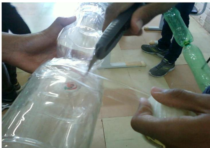
Figura 3.5 – Colocação de fita adesiva transparente de largura 5 cm no rasgo de comprimento de 7 cm, com duas voltas, para vedação das garrafas.
